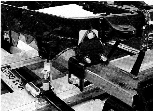
Universalité de l'ancrage et du contrôle par symétrie avec la mesure METRO 2000
